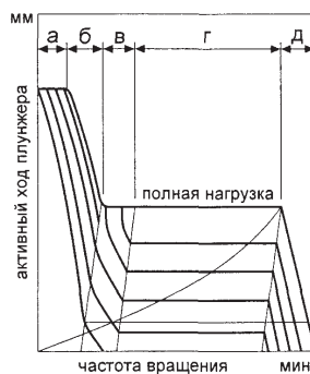
Рис. 2.25. Скоростные характеристики топливоподачи ТНВД с двухрежимным регулятором:
