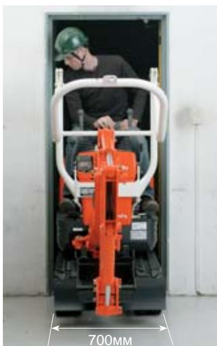
При уменьшении ширины колеи гусениц до 700 мм, экскаватор K008-3 может легко преодолевать большинство дверных проемов, обеспечивая доступ к площадкам внутри помещений.
