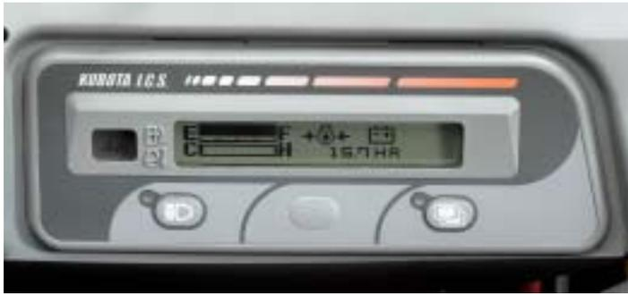
Это новаторское усовершенствование, которое всегда уведомляет оператора о жизненно важных параметрах работы экскаватора КХ61-3. Интеллектуальная система управления компании Kubota оснащается предупред-ми индикаторами для двигателя, топлива, температуры и масла; режима работы, который обеспечивает точный поиск и устранение неисправности; и стандартными индикаторами, которые отображают текущие рабочие условия, такие как обороты двигателя, наработку и многое другое.
