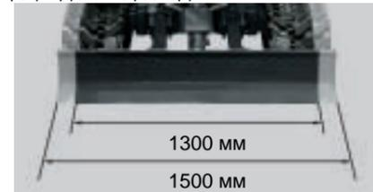
Увеличьте ширину колеи гусениц, чтобы обеспечить повышенную устойчивость или уменьшите ширину, чтобы проходить узкие места.
