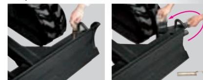
При простом удалении всего одного штифта полотно гусениц экскаватора сразу же регулируется по размеру.
